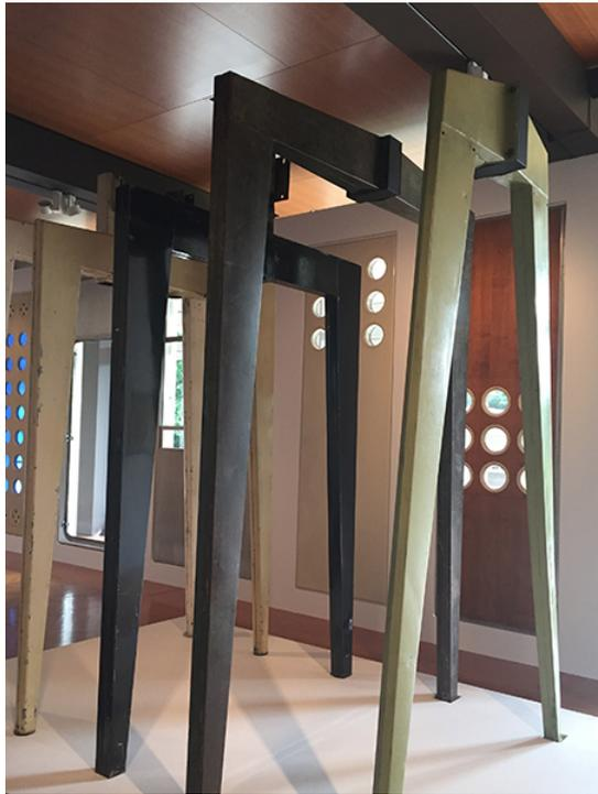
そうした仮設住宅は、すでに特許を取得していたという、特徴的な門型フレームを用いて、迅速に組み立てられ、必要に応じて解体し、別の場所へ移動して再度組み立てられるようにデザインされています。戦後不足していた鉄鋼素材は最小限に抑え、木製の軽量のプレハブ素材を使用することで実現したそう。
