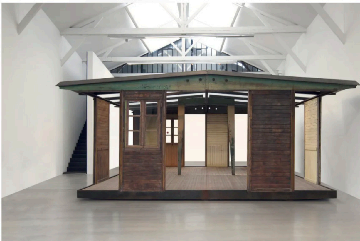
Jean Prouvé, 6x6可拆卸房屋，1944年。房子的设计初衷是为第二次世界大战结束后流离失所的人群提供临时住所。© Galerie Patrick Seguin
